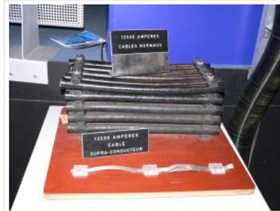
Elektrische Kabel für Teilchenbeschleuniger am CERN; oben: normale Kabel für LEP; unten: supraleitende Kabel für den LHC (Foto: [Wikimedia/Rama](#))
