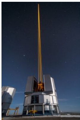
Eine Ingenieurleistung vom Allerfeinsten – Die Four Laser Guide Star Facility (4LGSF) erzeugt in der chilenischen Atacamwüste mit vier 22-Watt-Lasern in 95 km Höhe künstliche Laserleitsterne (Foto: Wikimedia/ESO, F. Kamphues )
