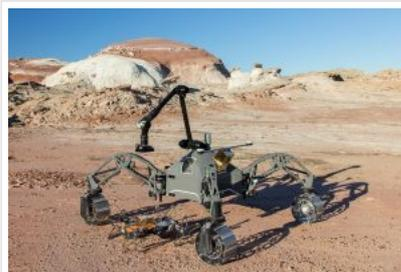
Weltraumrobotik: Autonomer Schreit- und Fahrrover während eines Feldversuches in der Wüste Utahs/USA (Foto: Deutsches Forschungszentrum für Künstliche Intelligenz/DFKI)
